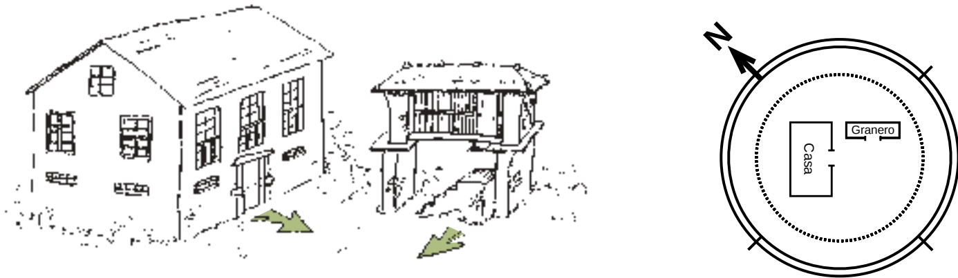
Figura II-15. Configuración general y disposición más frecuente de una agrupación vivienda-granero de secado en la zona costera del occidente de Asturias.
